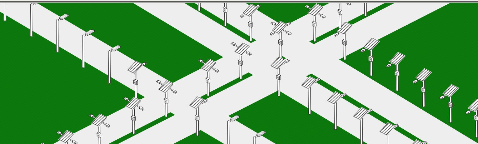
**Penerangan Jalan Umum Tenaga Surya (PJUTS) atau PJU Solar Cell (Solar Street Light) untuk jalan/kawasan yang tidak berada dalam area jaringan PLN atau untuk efisiensi biaya penerangan.**
