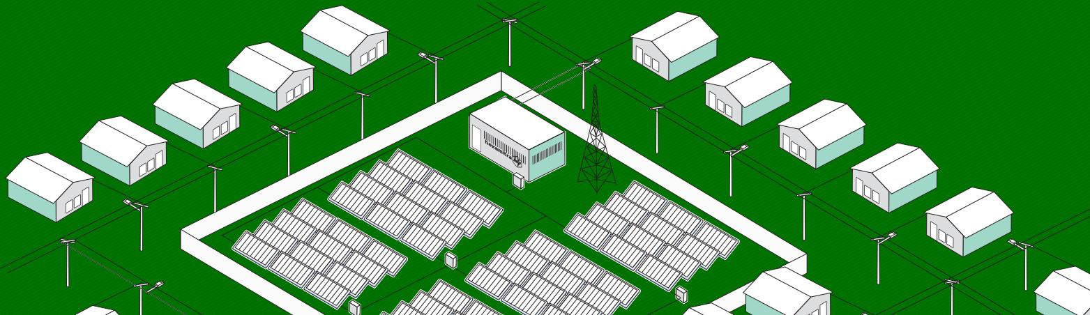
**Pembangkit Listrik Tenaga Surya (PLTS) Off Grid / Mini Grid merupakan sistem pembangkitan listrik matahari dimana PLTS beroperasi secara independen di lokasi yang tidak terdapat jaringan grid / PLN.**
